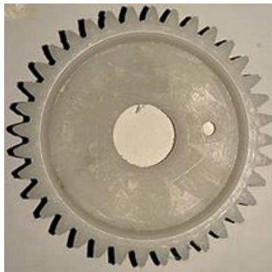
شکل ۱. نمای بالا از چرخ‌دنده پلی‌استال تزریقی
