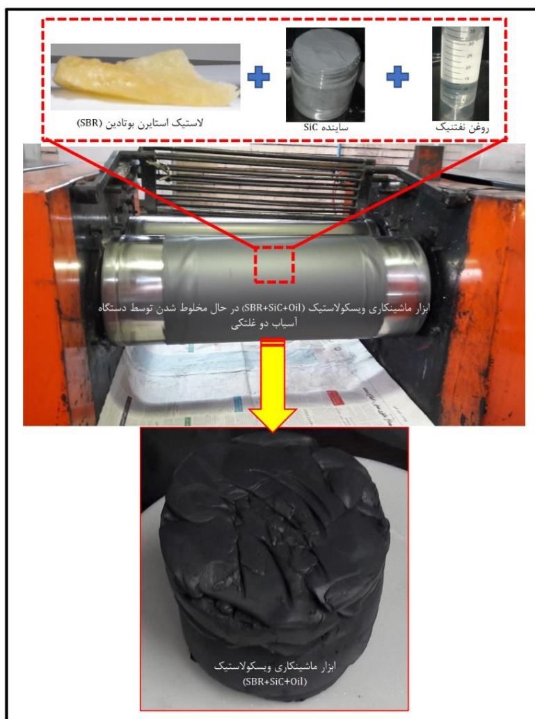
شکل ۴. مراحل ساخت یک ابزار ماشین کاری.
