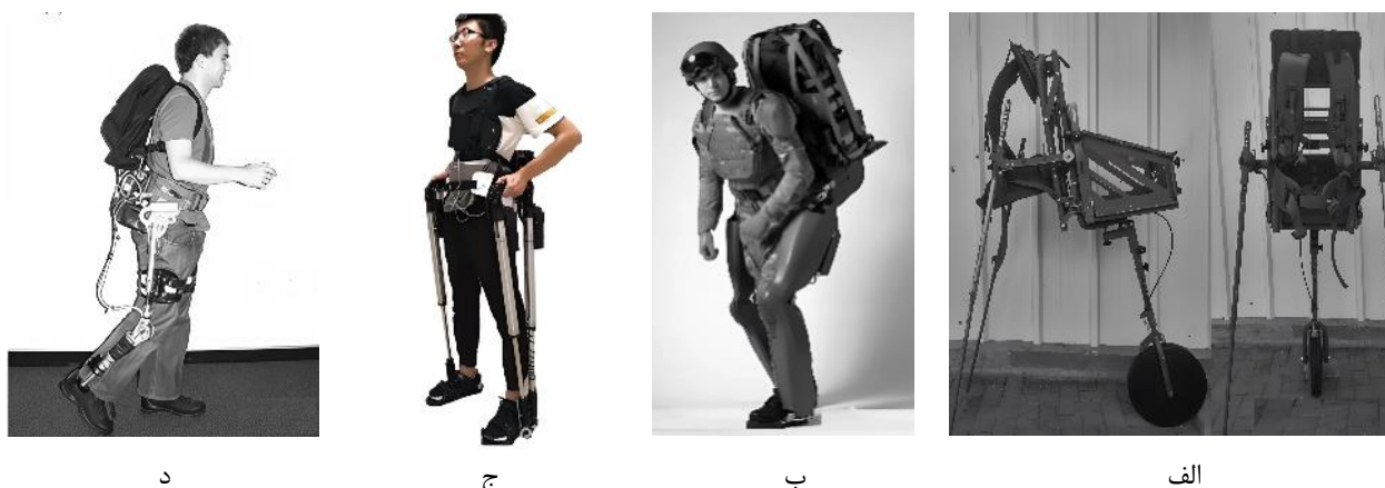
شکل ۶. دستگاه‌هایی برای انتقال وزن بار به زمین. الف: دستگاه مبتنی بر چرخ [۱۰۵]. ب: BLEEX [۹۷]. ج: اگزواسکلتون اندام تحتانی با ساختار موازی [۱۰۲]. د: اگزواسکلتون با فنرهای مفصلی و دمپ‌های متغیر [۵۴]
