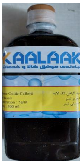
شکل ۵ نانو کلونید اکسید گرافن مصرفی بصورت مایع با غلظت ۵٪
