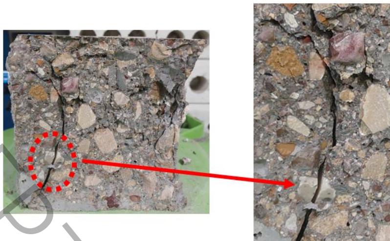
شکل ۷ شکست نمونه شاهد از سنگدانه
