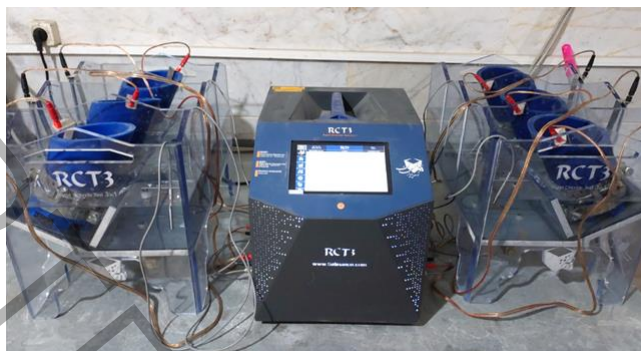
شکل ۱۱ آزمایش تست نفوذ یون کلراید در بتن به روش RCMT Figure 11 Chloride ion penetration test in concrete using the RCMT method
