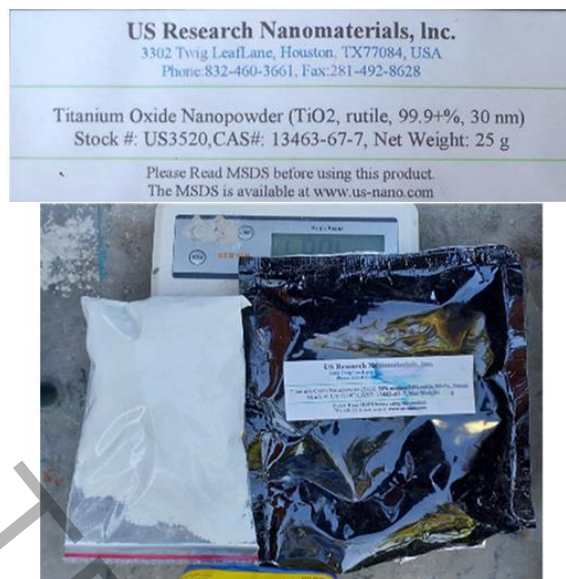
شکل ۴ نانو اکسید تیتانیوم مورد استفاده در این تحقیق Figure 4 titanium oxide nano powder used in this research
