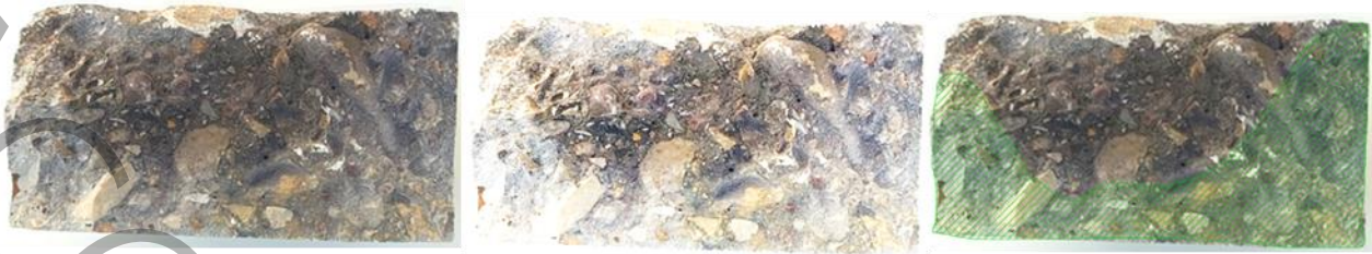
شکل ۱۷ نمونه GT-5 پس از نفوذ یون کلراید
