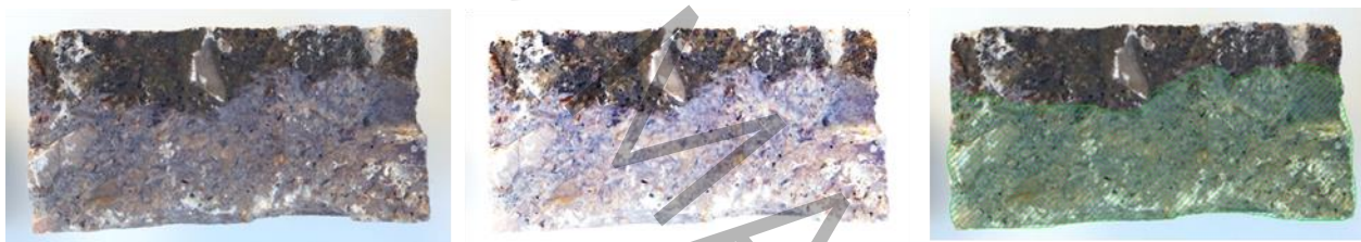
شکل ۱۴ نمونه GT-2 پس از نفوذ یون کلراید
