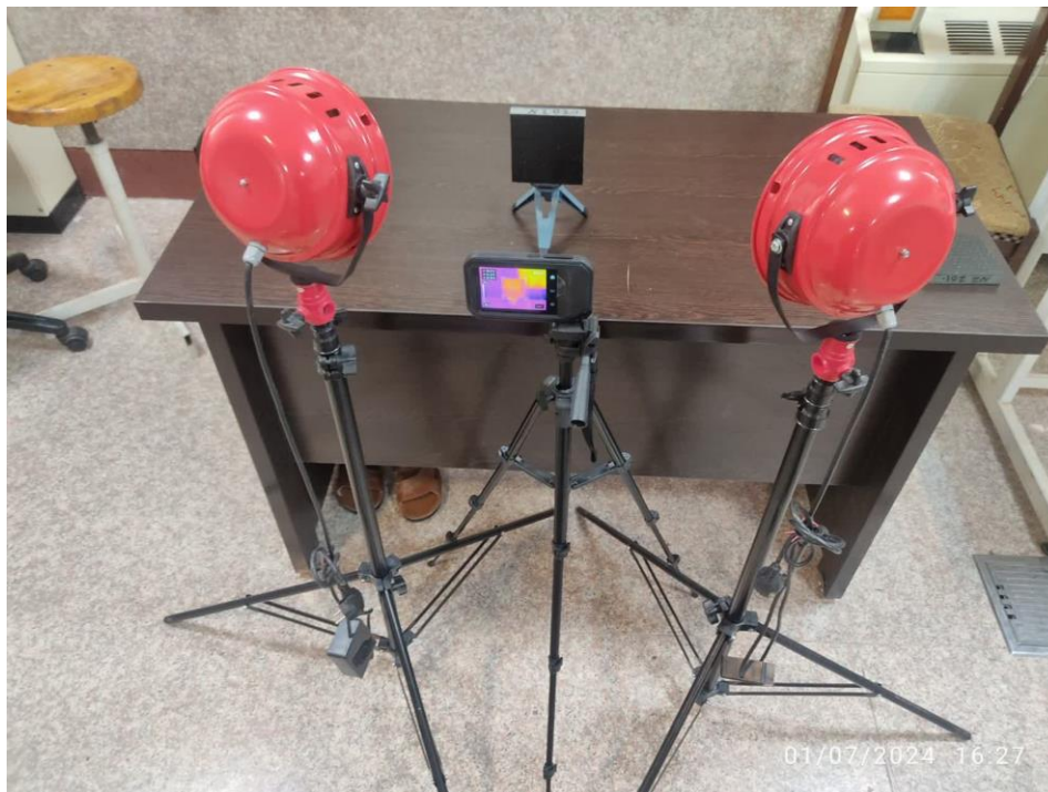
شکل ۴. تجهیزات تصویربرداری مادون قرمز
