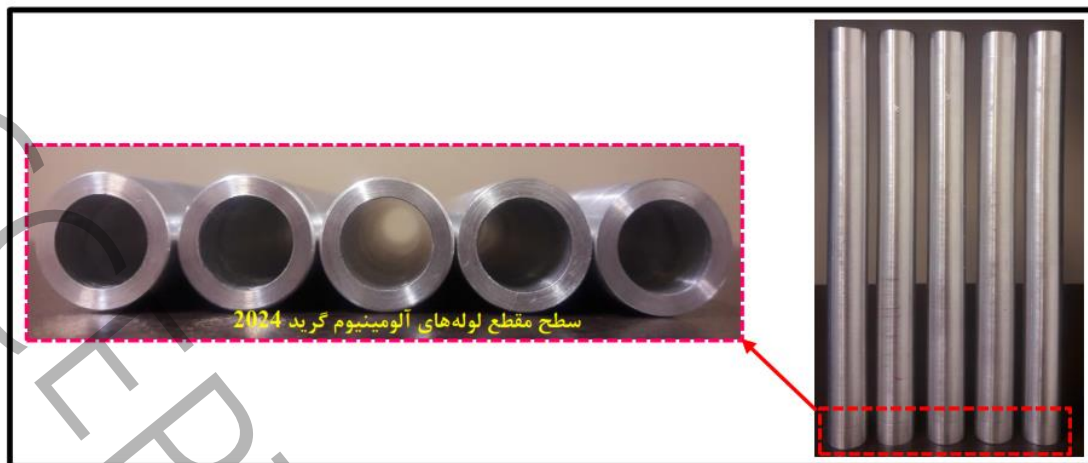
شکل ۶. تصاویر واقعی تعدادی از نمونه‌های لوله‌های آلیاژ آلومینیوم ۲۰۲۴. Fig. 6. Actual images of a number of 2024 aluminum alloy tubes samples.
