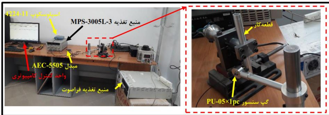
شکل ۳. تجهیزات اندازه‌گیری دامنه ارتعاش در فرآیند پرداخت کاری جریان ساینده مگنتورئولوژیکال به کمک میدان مغناطیسی دوار و ارتعاشات فراصوت.
