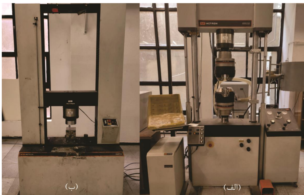
شکل ۱. نمایی از دستگاه‌های تست (الف) کشش اینسترون ۸۵۰۲ و (ب) فشار اینسترون ۴۲۰۸.
