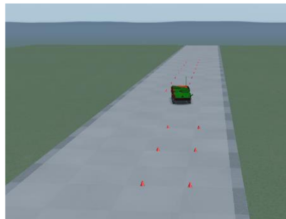
شکل ۷. تست تغییر دوبل مسیر (خودرو قرمز رنگ فاقد فنر بادی و خودرو سبز رنگ مجهز به فنر بادی می‌باشد).
