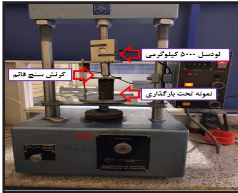
شکل ۳. دستگاه مقاومت فشاری محصور نشده.
