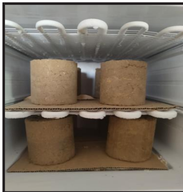
شکل ۴. فرآیند آماده سازی نمونه‌های سیکل ذوب-یخ
