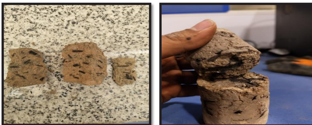
شکل ۱۰. نمونه پوسیده شده بعد از آزمایش
