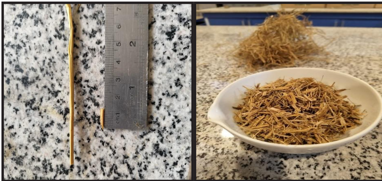
شکل ۲. آماده سازی الیاف جهت نمونه سازی.
