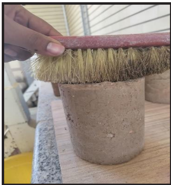
شکل ۴. فرآیند آماده سازی نمونه‌های سیکل ذوب-یخ
