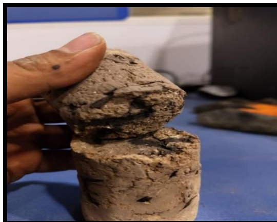
شکل ۱۰- نمونه پوسیده شده بعد از آزمایش Figure 10. Decayed sample after test
