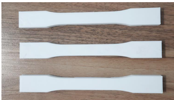
شکل ۱. سه نمونه از تیرهای دمبلی شکل بر اساس استاندارد D638 و ساخته شده توسط چاپگر سه‌بعدی.
