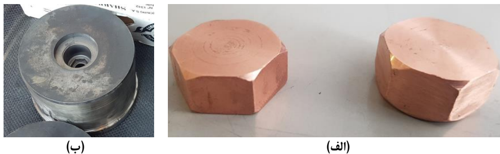
شکل ۷. الف) قطعه مسی به عنوان ابزار اسپارک، ب) شش ضلعی ایجاد شده در قالب توسط دستگاه اسپارک.
