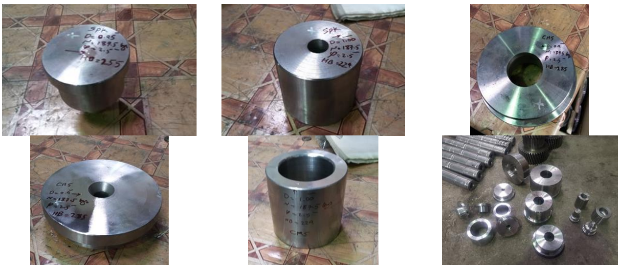
شکل ۶. آماده‌سازی قطعات قالب.
