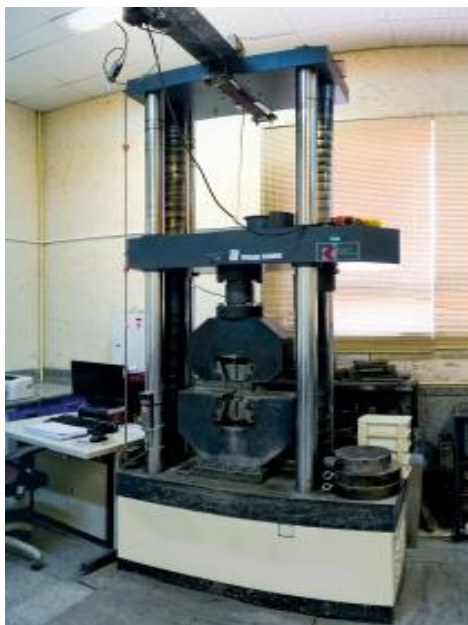
شکل ۲. دستگاه تست کشش ۳۰۰ ژول (SIT-300E) به منظور تعیین خواص مکانیکی قطعه کار.
