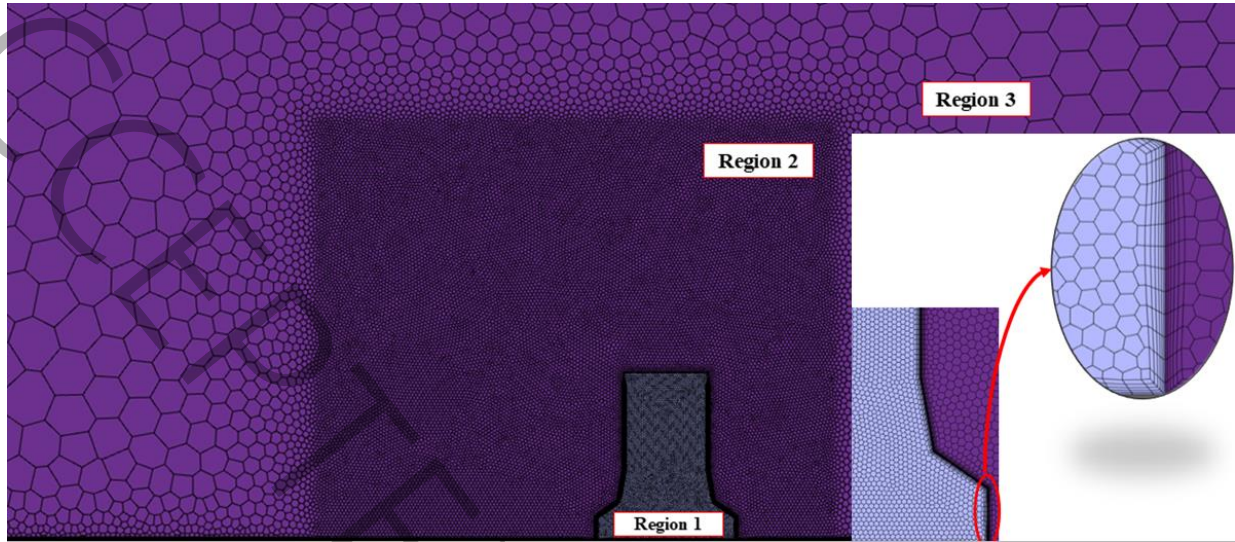
شکل ۵. نمایش جزئیات شبکه با المان‌های چندوجهی در صفحه منطبق بر صفحه تقارن برج خنک‌کن.
