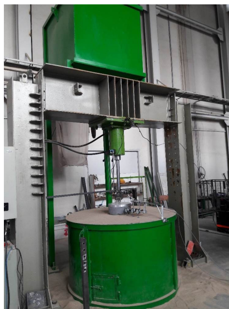
شکل ۵: نمای کلی از سیستم بارگذاری و اعمال نیرو
