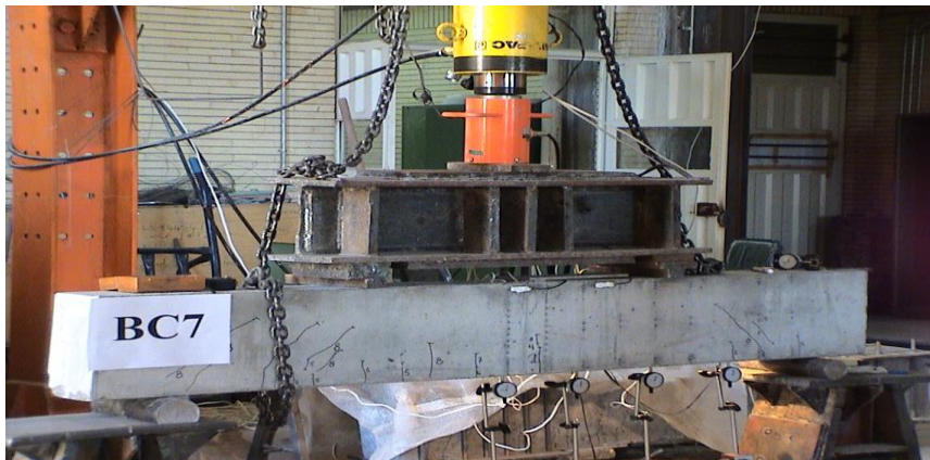
شکل (۳): نحوه بارگذاری، پیشروی ترکها در تیر BC7
