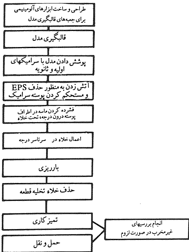
شکل ۱۱: فلوجارت روش رپلی کست با پوسته سرامیکی (مرجع ۹)
