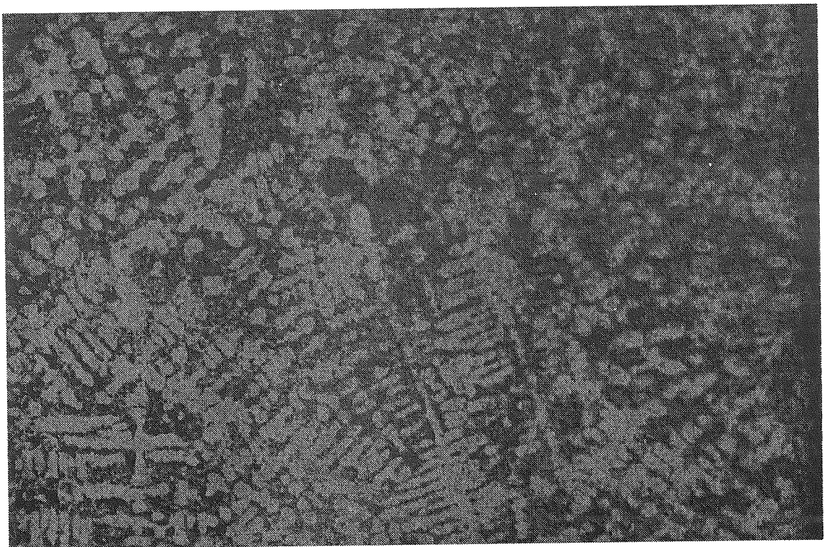
شکل (۱۳) تصویر میکروسکوپی نمونه ۱۷. محلول اچ نیتال ۲٪. بزرگنمایی ۱۰۰× حاوی ۸۵٪ پرفیت و ۱۵٪ فریت. دندریت های استنیت اولیه در این تصویر مشخص هستند.
