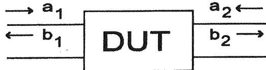
شکل (الف) تشابه پارامترهای پراکندگی S و مشخصه های انعکاسی $\Gamma$ در مدلسازی جسم مورد آزمایش (DUT) و اتافک مورد آزمایش (CUT).
