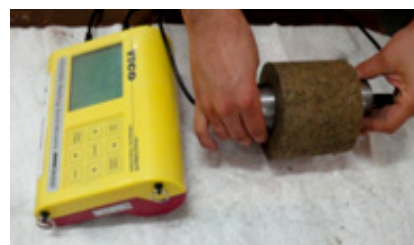
شکل ۲ آماده سازی نمونه خاک متراکم شده (بالا) و عبور امواج فراصوت از نمونه بصورت مستقیم (پایین)
