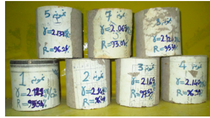
شکل ۸: نمونه خاک‌های متراکم شده برای آزمایش چکش ضربه Fig. 8. Sample Soil Samples for Impact Hammer Test
