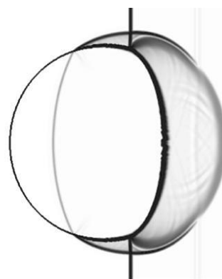
شکل (۲): بررسی استقلال معادلات نسبت به اندازه شبکه و همگرایی جواب‌ها برای مسئله برخورد شاک با حباب هلیوم در زمان ۲۳۰ میکرو ثانیه، به ترتیب از چپ به راست: ۱۵۰×۵۰، ۳۰۰×۱۰۰، ۶۰۰×۲۰۰، ۱۲۰۰×۴۰۰.
