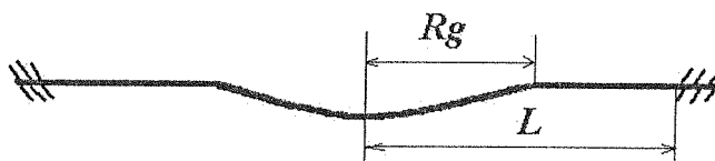
شکل (۴) گسترش موج برشی در زره کامپوزیتی و تغییر شکل عمومی آن.
