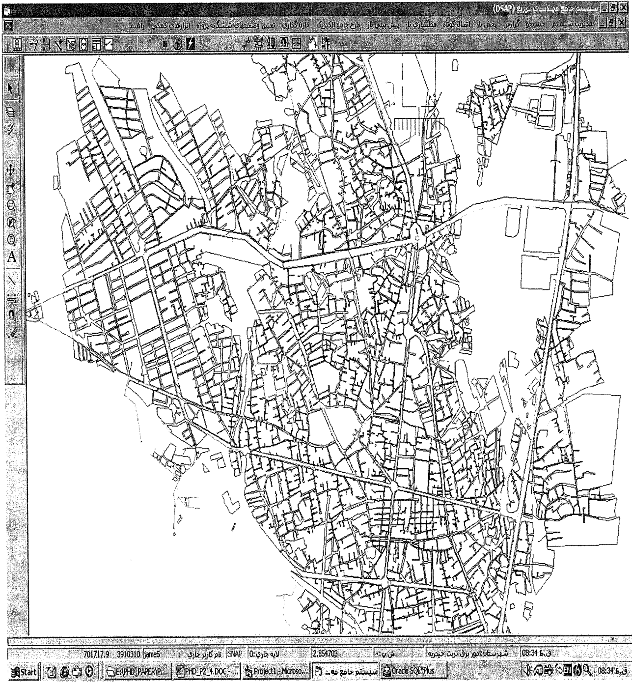
شکل (ج- ۱): شمای تک خطی شبکه توزیع در محیط جغرافیایی-الکتریکی نرم افزار LAP_Input.
