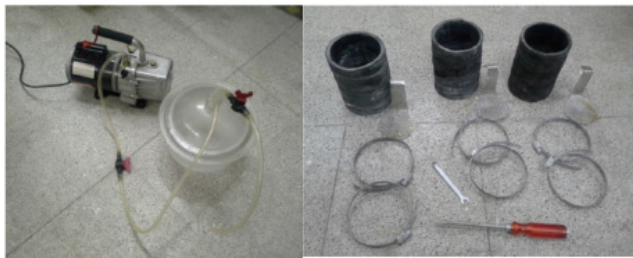
شکل ۶: وسایل مورد نیاز آزمایش تسریع شده یون کلرید Fig. 6. The required equipment for rapid chloride migration test
