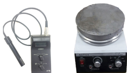
شکل ۳: همزن مغناطیسی و دستگاه رسانایی سنج مورد استفاده در آزمایش تعیین خاصیت پوزولانی مواد
