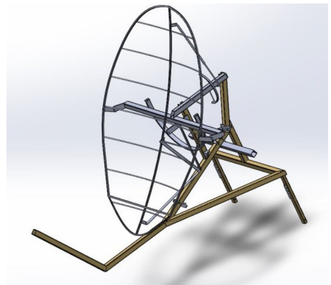
Fig. 10. Scheffler standing reflector designed by Solidworks software شکل ۱۰: متمرکز کننده ایستاده سفلر طراحی شده با نرم افزار سالیدورکز
