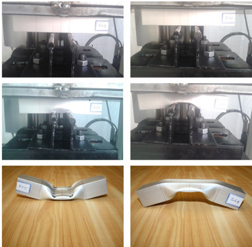
Fig. 4. The Deformation of the profile during indentation process. شکل ۴: نحوه تغییر شکل پروفیل طی فرایند بارگذاری دندان‌های
