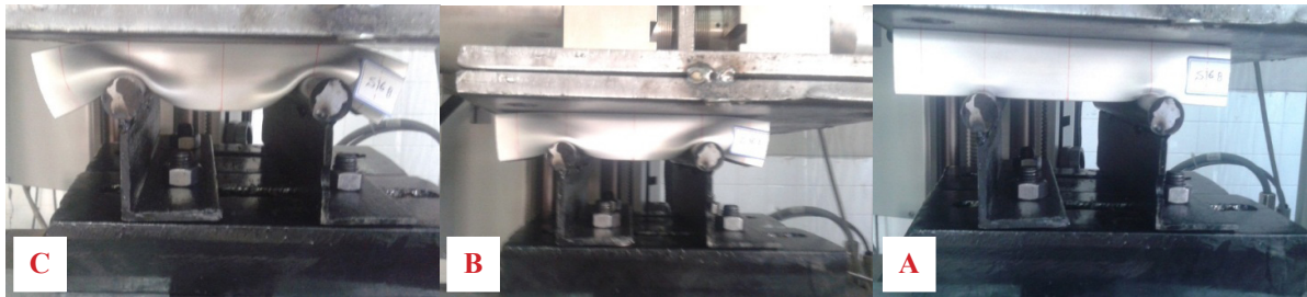
Fig. 3. Up) Force-displacement diagram for specimen S_{16} under indentation, Down) Deformation of the specimen under loading. شکل ۳: بالا) نمودار نیرو-جابجایی دندان‌گذاری نمونه S_{16} ، پایین) تغییر شکل نمونه در حین بارگذاری
