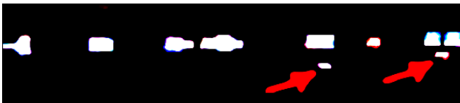
شکل ۱۴: انحراف قطره‌ها تحت اثر میدان الکتریکی اعمال شده Fig. 14: Deviation of droplets in the presence of an applied electric field
