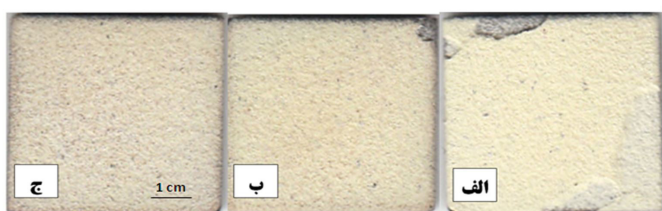
شکل ۸: سطح نمونه پوشش درجه‌بندی شده پس از اعمال شوک حرارتی در حالت (الف) پوشش دولایه معمولی، (ب) پوشش درجه بندی شده سه لایه و (ج) پوشش درجه بندی شده پنج لایه
