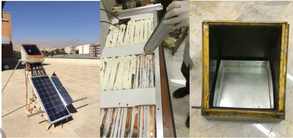
شکل ۵: قرار دادن سینی حاوی آب شور در داخل مخزن آب (سمت راست) - اتصال لوله حرارتی به صفحه مسی با جوشکاری و چسب سیلیکونی و عایق کردن لوله‌های حرارتی با استفاده از اسپری فوم (عکس وسط) - شکل نهایی سیستم و نصب آینه بر روی فتوولتائیک (سمت چپ)
