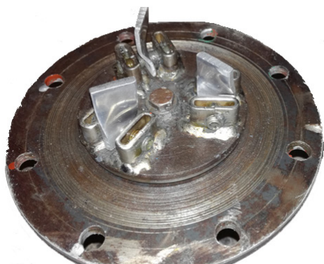
شکل ۷: نحوه گیره‌بندی قطعه کارها روی صفحه نگهدارنده
