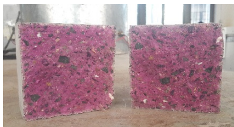
شکل ۵: نمونه‌ی بتنی، پس از پاشیده شدن محلول شاخص
