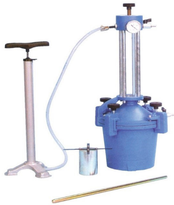
شکل ۲: دستگاه اندازه گیری درصد هوای بتن
