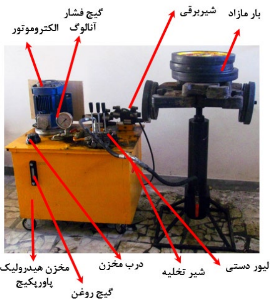
شکل ۱: مجموعه کامل سیلندر هیدرولیک و منبع قدرت هیدرولیکی Fig. 1. Complete set of hydraulic cylinder and hydraulic Power-package
