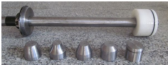
شکل ۳: بالا طراحی ضربه‌گیرها: (a) ضربه‌گیر استوانه‌ای، (b) ضربه‌گیر مخروطی، (c) ضربه‌گیر سهمی‌وار، (d) ضربه‌گیر پارابولیک و (e) ضربه‌گیر دومخروط و پایین اجزای تشکیل دهنده دسته پیستون
