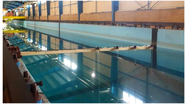
شکل ۶: روش نصب حسگرهای اندازه‌گیری ارتفاع موج
