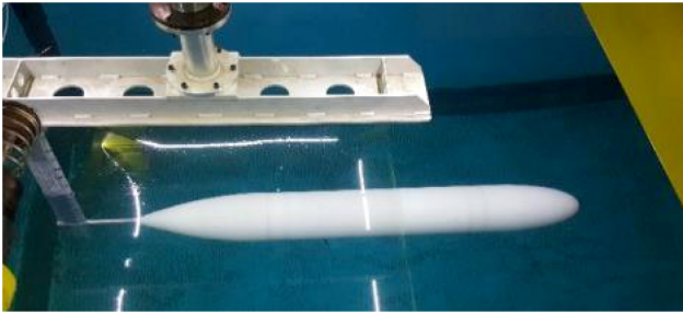
شکل ۴: زیردریائی مدل متصل به سامانه آزمایش مقید
