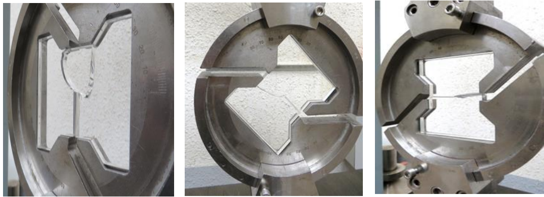
شکل ۶: آزمایش شکست نمونه‌ها، بارگذاری در (الف) مود یک، (ب) مود مرکب ۴۵ درجه، (ج) مود دو
