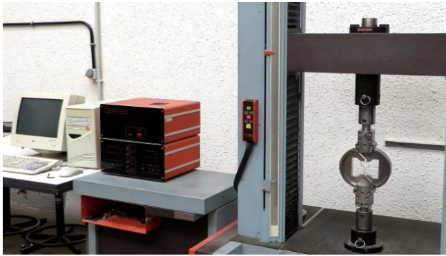
شکل ۳: دستگاه آزمایش کشش با گیره اصلاح شده آرکان و نمونه کششی نصب شده روی آن
