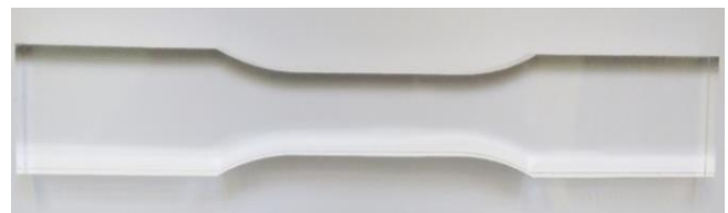
شکل ۲: نمونه آزمایش استاندارد کشش Fig.2: Schematic of dog-bone tensile specimen
