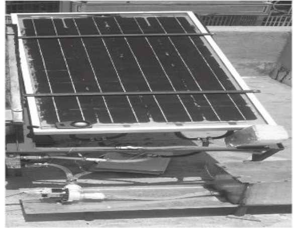
شکل ۲: تصویری از دستگاه آزمایش فتوولتائیک حرارتی مستقر در گروه مهندسی مکانیک دانشگاه سیستان و بلوچستان
