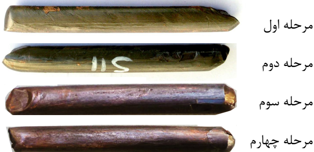
شکل ۵: چهار مرحله ایکپ موفق نمونه‌های تیتانیومی در دمای 260^{\circ}\text{C}
