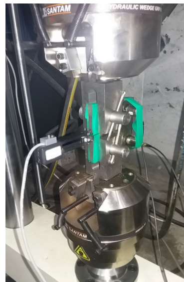
شکل ۵: نمایی از قطعه، فیکسچر، سنسورها و اکتسنومتر
