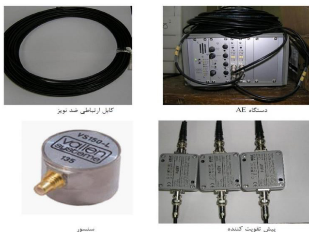
شکل ۴: تجهیزات سیستم آکوستیک امیشن Fig4: Acoustic Emission Apparatus
