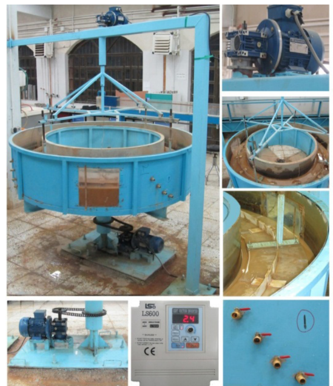
شکل ۳: اجزای فلوم دایره ای Rotating Flume Assembly
