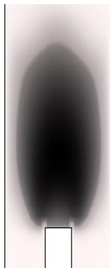
شکل ۱۳: شکل شعله‌ی متان با حضور میدان مغناطیسی کاهشدهنده (شدت میدان B=1 T)
