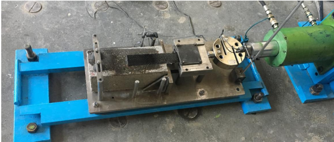
شکل ۴. تصویر دستگاه برش مستقیم Fig. 4. Image of the Single-shear pull test apparatus
