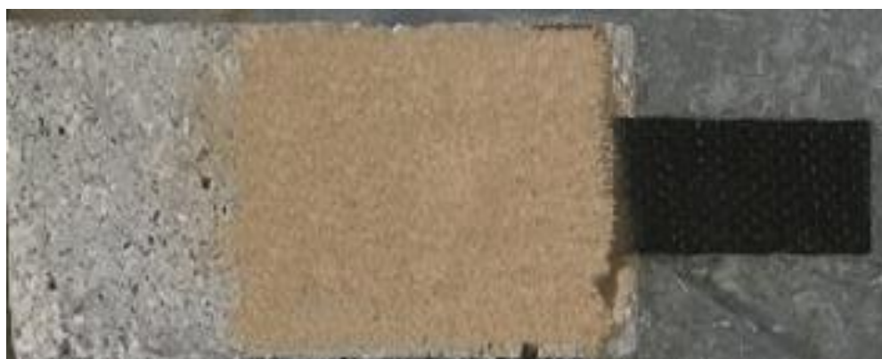
شکل ۳. سطح پوشانده شده نمونه توسط ماسه رنگی Fig. 3. Surface covered by colored sand
