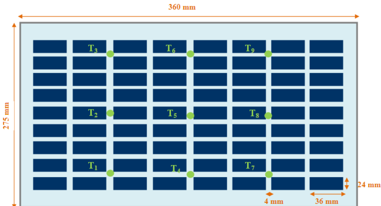
شکل ۲: شماتیک ماژول فتوولتائیک مورد مطالعه و نحوه قرارگیری ترموکوپل‌ها روی سطح آن.
