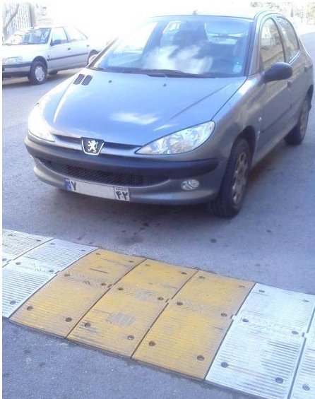
شکل ۱۷: خودرو در حین انجام آزمون (عبور از سرعت گیر)
