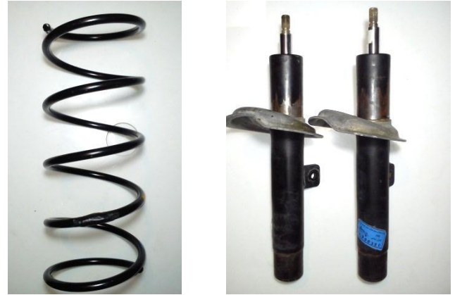
شکل ۱۶: استفاده از اجزای معیوب کمک‌فنر و فنر در سیستم تعلیق جلوی خودرو
