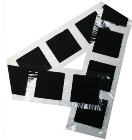
شکل ۶: مجموعه غشاء الکتروود (شرکت PaxiTeck)
