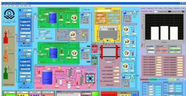
شکل ۱۱: نرم افزار تست، کنترل و مانیتورینگ استک پیل سوختی
