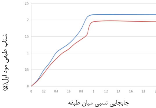
شکل ۱۶. مقایسه منحنی میانه IDA قاب ستون-پیوند و قاب خمشی تحت اثر توالی لرزه‌ای در سطح عملکرد IO Fig. 16. Median IDA curve considering MS-AS effect for Moment Frame and Linked-Column Frame in IO performance level
