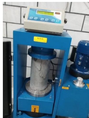
شکل ۱. تعیین مقاومت فشاری یکی از نمونه های بتنی استوانه ای استاندارد تحقیق
