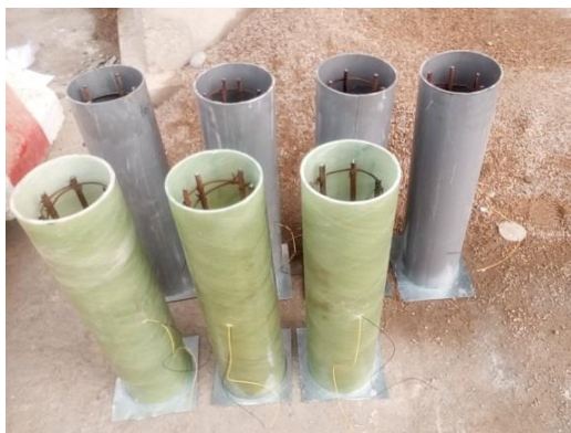
شکل ۵. نحوه قرارگیری قفسه میلگردها درون غلاف های GRP و قالب PVC Fig. 5. How to place the rebar rack inside the GRP casings and PVC mold
