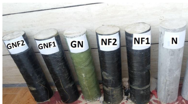
شکل ۶. ستون های تحقیق بعد از اعمال دورپیچ CFRP Fig. 6. Research columns after applying CFRP wrapping
