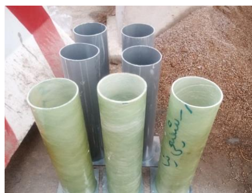
شکل ۴. لوله های GRP و قالب های PVC Fig. 4. GRP pipes and PVC molds
