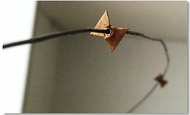
شکل ۲: نمونه ای از پرهی جاگذاری شده درون لوله مورد مطالعه
