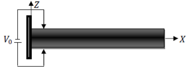
شکل ۱: شمای نانو عملگر پیزوالکتریک تحت ولتاژ V_0
