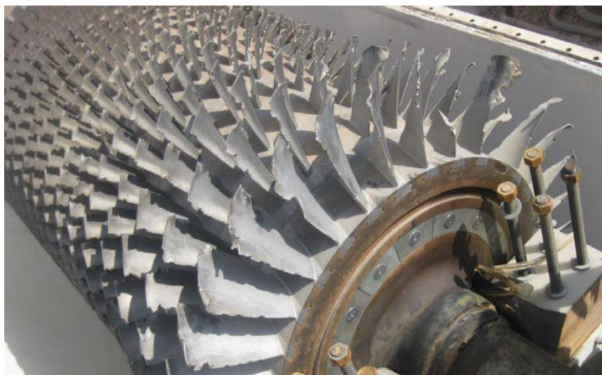
شکل ۲: تخریب پره‌های متحرک تا ردیف‌های میانی
