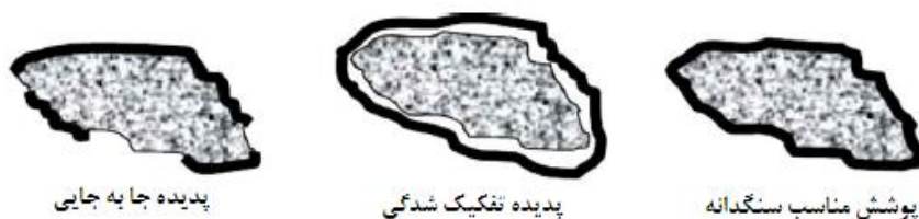
شکل ۲. تفاوت پدیده جا به جایی و جداشدگی [۸]
